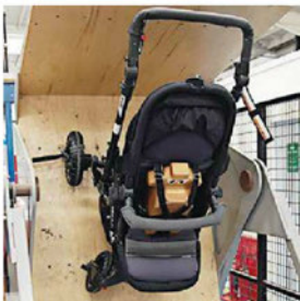
Ukázka laboratorního testu odolnosti zapínadel.
